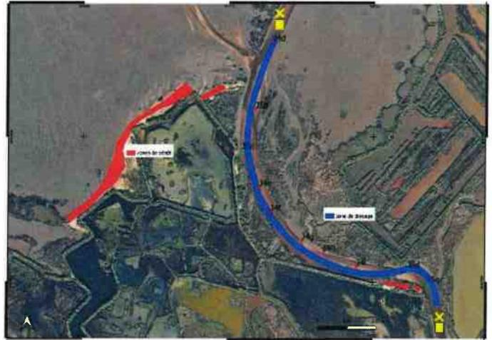
L'installation sera balisée par 2 croix de St André situées de part et d'autre de la drague. Celles-ci seront déplacées au fur et à mesure de l'avancement du chantier.
